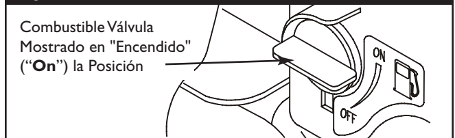
Figura 35 - Válvula de Control de Combustible
